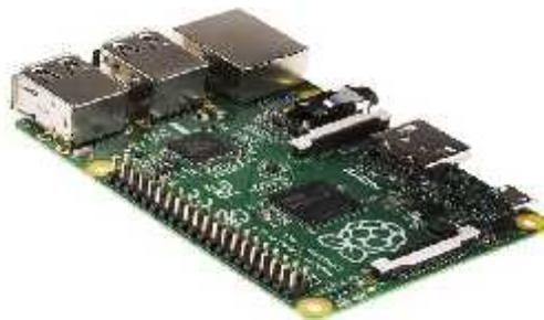
**Gambar 1. Perangkat Keras Raspberry Pi. (Adafruit, 2017).**
